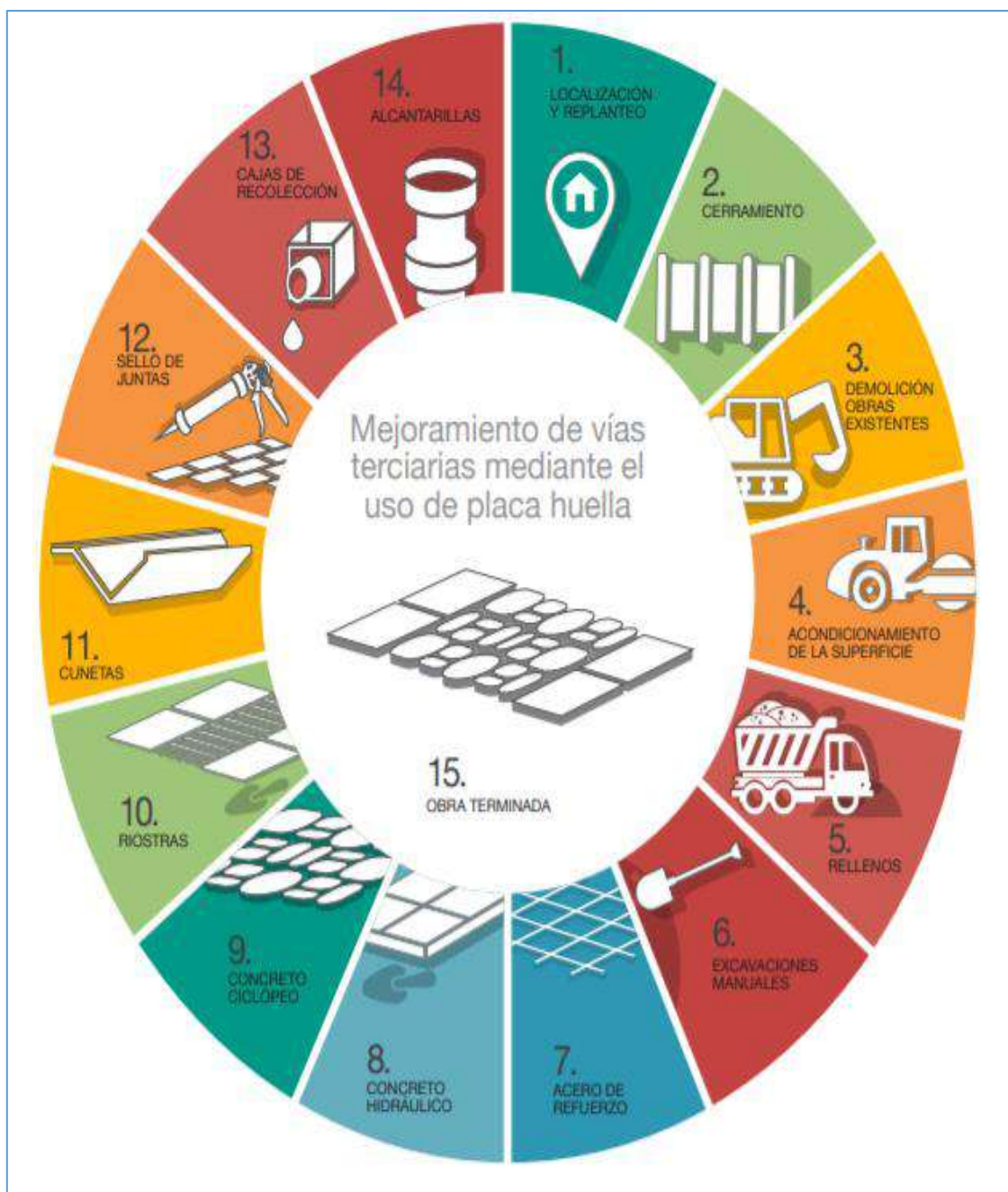
Ilustración 8 Descripción del proceso en placa huella
